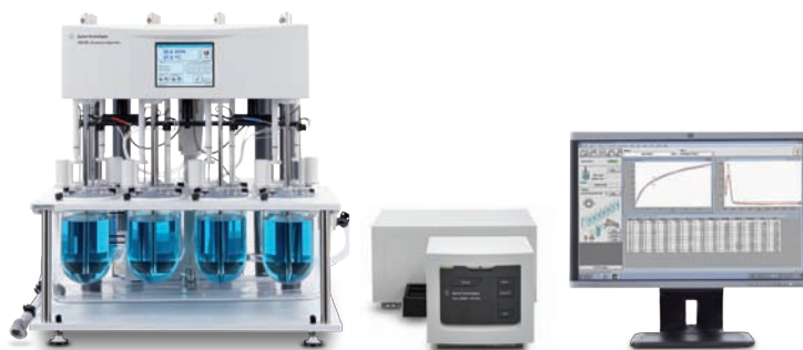
Системы оперативного определения растворимости и УФ-анализа Agilent на базе диодной матрицы: прибор для определения растворимости 708 со спектрофотометром Cary 8454 UV-Vis.
