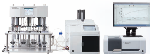
Использование Agilent 850-DS с системой online анализа Cary 60 с многокюветным приспособлением позволяет осуществлять оценку растворимости и УФ-анализ в режиме online, а также автономный отбор проб для анализа методом жидкостной хроматографии высокого давления.
